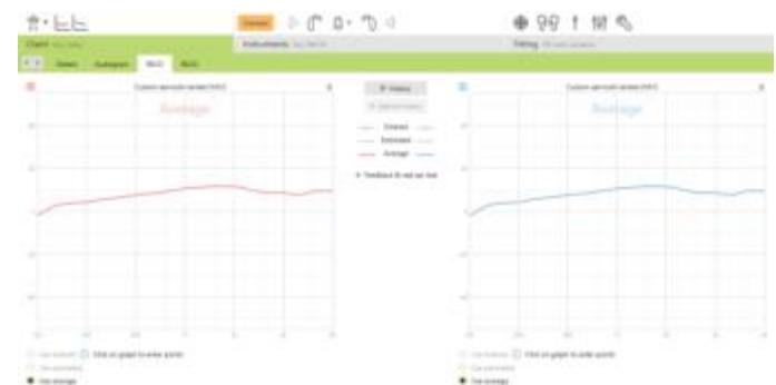
**[Standard verwenden]** – die durchschnittlichen RECD-Werte einer Otoplastik, basierend auf dem Alter des Kindes und dem verwendeten Algorithmus (z.B. DSLv5 oder NAL-NL2).
